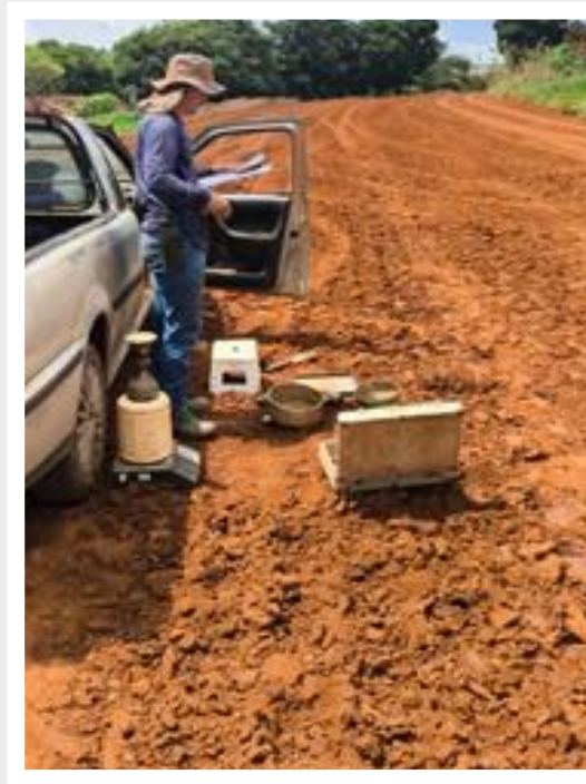
Controle tecnológico (ensaios de compactação) – Março 2026
