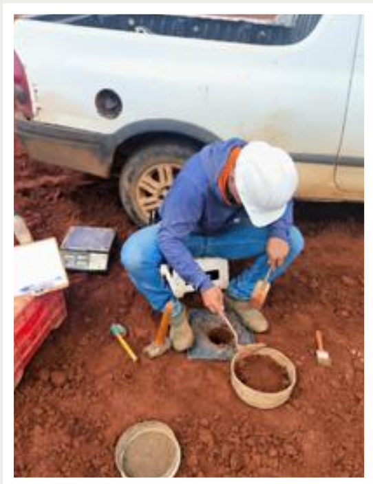
Controle tecnológico (ensaios de compactação) – Março 2026
