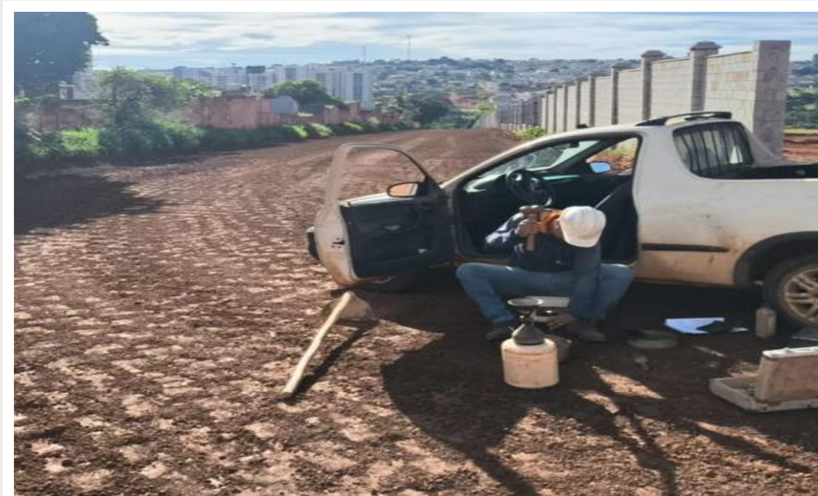
Controle tecnológico (ensaios de compactação) – Março 2026
